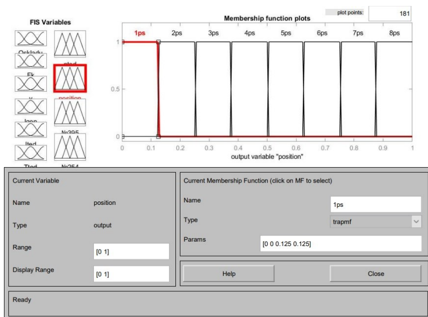
Рисунок 3.12. Дефазифікація «Положення рукоятки контролера машиніста»
